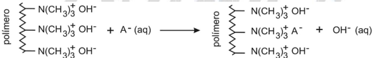
No tratamento da água com as resinas de troca iônica, a água atravessa colunas de vidro ou plástico, preenchidas com a resina sob a forma de pequenas esferas. O líquido que sai da coluna é chamado de eluído.
