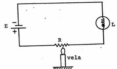
81. Considere o circuito acima, constituído por uma pilha E, fios de cobre, uma lâmpada de lanterna L, e uma resistência metálica R. A lâmpada está acesa brilhando fortemente. Aquecendo a resistência com a chama de uma vela, podemos afirmar que o brilho da lâmpada:
