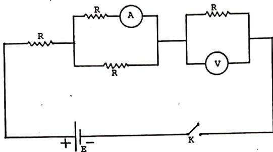
82. O amperímetro A e o voltímetro V do circuito acima são ideais. Com a chave K ligada, o amperímetro marca 1 mA e o voltímetro 3V. Desprezando-se a resistência interna da bateria, quais os valores de R e E ?
