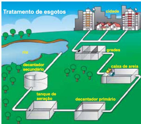
No tanque de aerção, o ar fornecido faz com que os micro-organismos ali presentes multipliquem-se e alimentem-se de material orgânico, formando o lodo e diminuindo, assim, a carga poluidora do esgoto.
