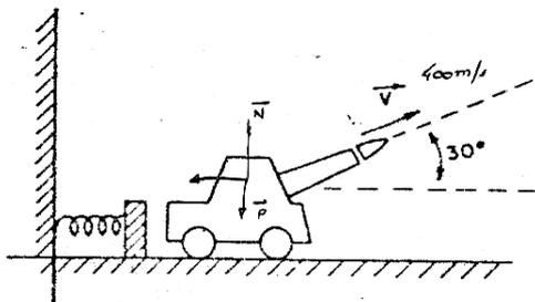
Sabe-se que inicialmente a mola não estava comprimida e que sofre, após o choque ocorrido, uma compressão máxima de  $20 \text{ cm}$ , o valor da constante elástica da mola (em  $\text{N/m}$ ) é
